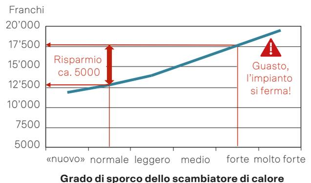
Costi annuali per l'energia di un impianto con una potenza (evaporatore) di 210 kW con scambiatori di calore con diversi gradi di sporcizia.
