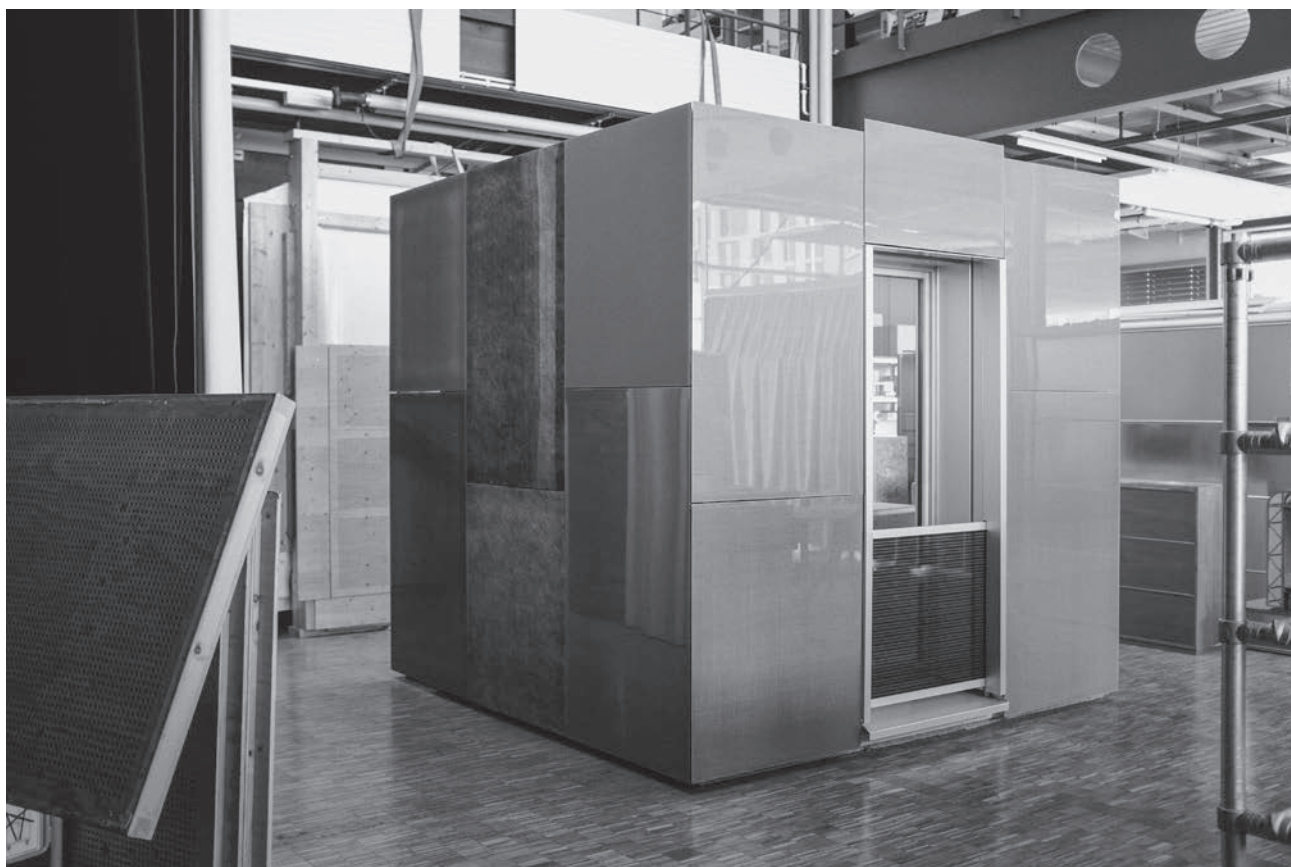
Il prototipo con i diversi moduli fotovoltaici al pianterreno del LAST presso il Politecnico di Losanna.
