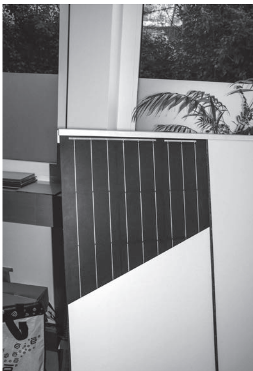
Uno sguardo dietro la pelle nanotecnologica del modulo solare bianco sviluppato al CSEM.
