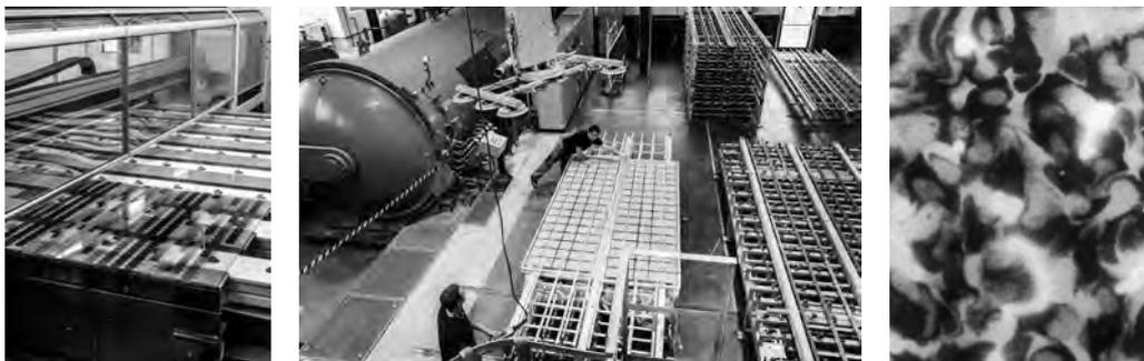
La stampante digitale di Ertl Glas e la produzione del materiale fotovoltaico presso Ertex Solar. All'ingrandimento al microscopio, la tonalità omogenea dei vetri di Solaris appare come una puntinatura.
