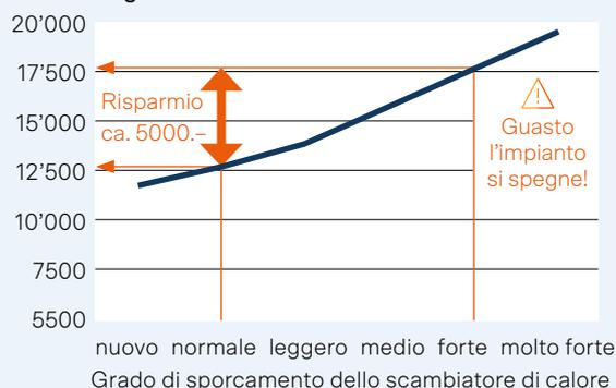
Grafico: costi energetici annuali di un impianto di refrigerazione con una potenza di raffreddamento di 210 kW a diversi gradi di sporramento degli scambiatori di calore.
