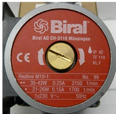
Figura 2: targhetta pompa. Fonte: Biral Redline M10-1
