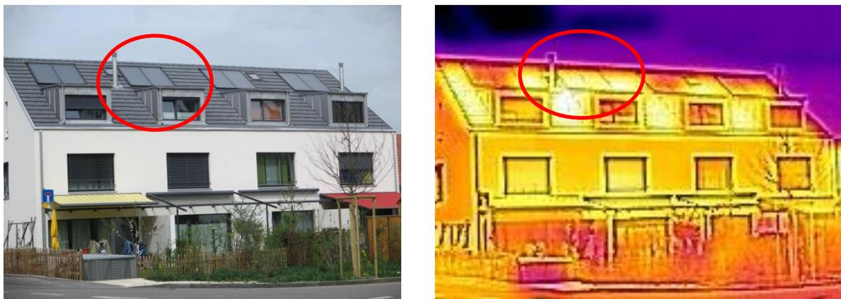
**Fig. 6:** Termografia di quattro campi collettori solari eseguita con FLIR C2 il 14/4/2015 a Reinach BL. Il secondo campo collettori da sinistra è surriscaldato, infatti presenta una temperatura identica alla temperatura del tetto. Se l'impianto trasmette correttamente energia solare, il collettore appare più scuro del tetto.
