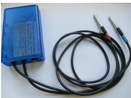
Fig. 2: Segnalatore di guasti con due sensori di temperatura, allacciamento alla rete ed emettitore acustico, sviluppato per una prova su 10 impianti solari da Energie Zukunft Schweiz.
