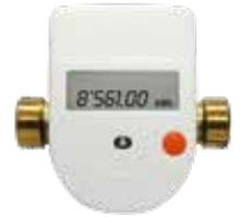
Nel misuratore di portata, nelle sonde termiche e nell'unità di calcolo i contatori di calore presentano delle tolleranze di misura. Gli errori massimi tollerati dell'unità di calcolo e delle sonde sono l'1% circa. L'errore principale è dovuto al misuratore di portata e può essere al massimo il 5%. In media le differenze per il contatore di calore arrivano a essere del 3% circa.
