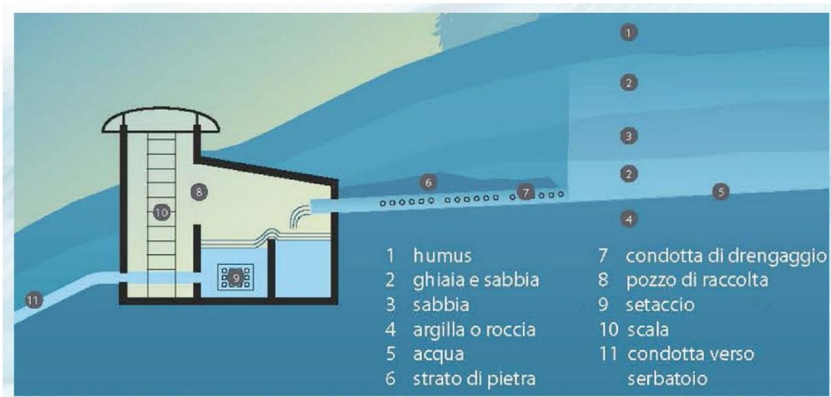
**Figura 3** Schema di un'opera di captazione per acqua potabile (© SSIGA 2015, www.trinkwasser.svgw.ch)
