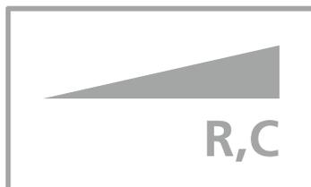
**Dimmer a taglio di fase discendente**, ad esempio per lampade alogene a bassa tensione con trasformatore elettronico o lampade LED. Per il funzionamento è necessario il carico minimo di pochi watt indicato. Con i LED può accadere che il carico sia insufficiente a causa del consumo di corrente ridotto.
