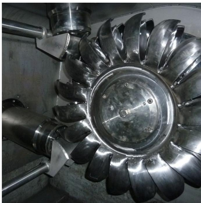
Centrale ad acqua potabile di Plan Sépey: ruota Pelton, monoblocco (fotografia di J-M Chapallaz)
