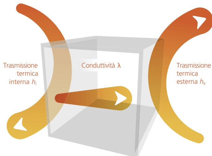
La trasmissione superficiale ( $h$ ) e la conduttività ( $\lambda$ ) influenzano il coefficiente U di un elemento costruttivo.
