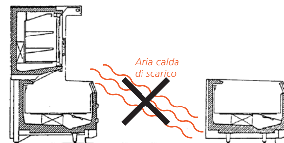
Fig. Collocare gli armadi di refrigerazione mobili in modo che l'aria calda in uscita di uno non soffi all'interno di un altro.
