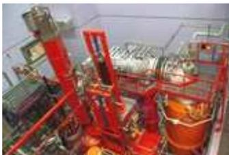
Impianto al plasma nel deposito intermedio centrale ZWILAG. Una parte delle scorie debolmente e mediamente radioattive viene vetrificata in questo impianto di incenerimento e fusione. Fonte: ZWILAG
