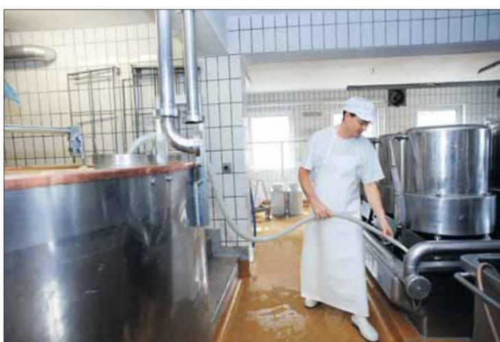
Con l'ausilio di questa invenzione, è possibile aspirare il 25 per cento circa del siero durante il riscaldamento a 55°C e risparmiare così tanta energia di riscaldamento.
