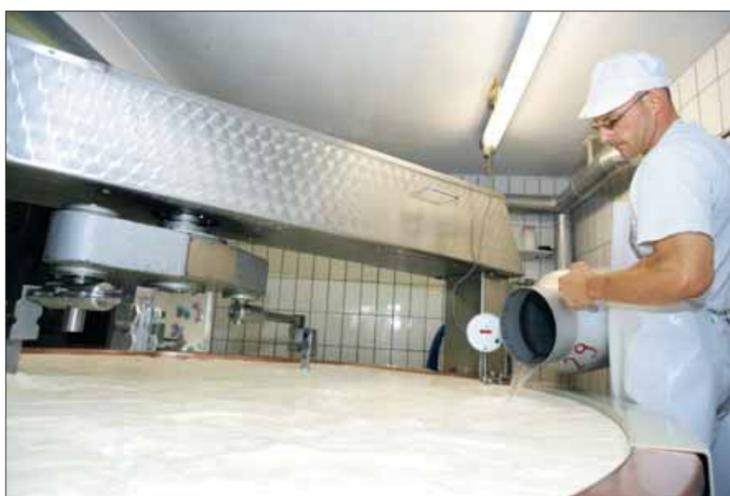
Ore 09:00: non appena la caldaia è piena, si aggiunge il caglio e il latte viene riscaldato a 32°C.
