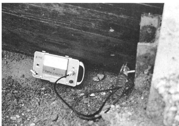
Figura 6.8 Strumento di misurazione dell'umidità del legno.
