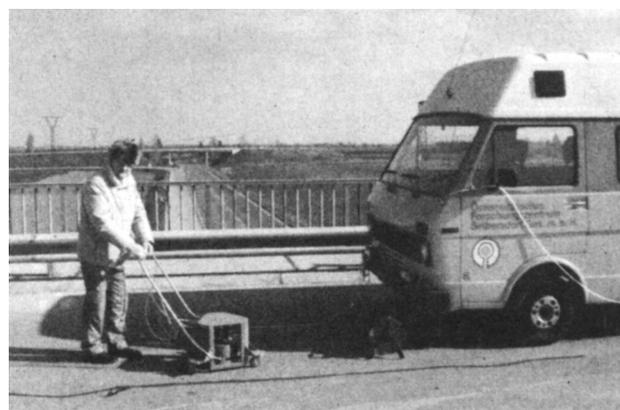
Figura 4.37 Localizzazione della perdita con il Tracer gas [4.60].
