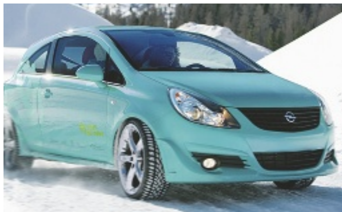
Der Opel Corsa 1.6 CNG, eine seriennahe Studie, verfügt über eine Reichweite mit Erdgas von über 500 km.
