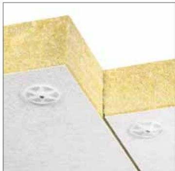
Fissare i pannelli isolanti con delle lunghe viti al soffitto. Così è possibile realizzare un eccellente isolamento termico e acustico in un'unica operazione.
