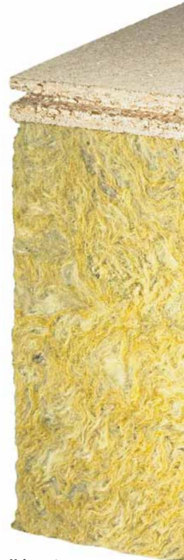
L'elemento per pavimenti di soffitte è formato da un pannello isolante autoportante in lana di roccia che viene incollato a filo con un pannello truciolare. Il pavimento calpestabile viene dunque posato contemporaneamente alla coibentazione. Per una maggiore facilità di montaggio i pannelli isolanti sono muniti di una scanalatura su tutti i lati.
