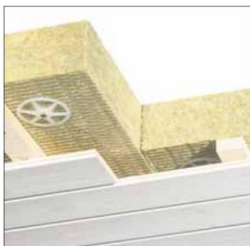
Per fissare il rivestimento, ancorare prima i listelli con lunghe viti distanziali al soffitto. Nella cavità c'è spazio sufficiente per far passare cavi elettrici.
