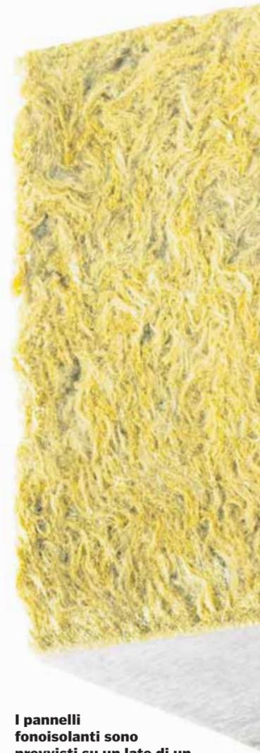
I pannelli fonoisolanti sono provvisti su un lato di un velo di vetro robusto, di colore chiaro che assomiglia a un intonaco. Vanno fissati direttamente al soffitto di calcestruzzo con graffe o tasselli oppure con un adesivo specifico tipo Silacolle.
