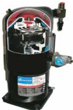
**Compressori ermetici:** Il motore e il compressore rappresentano un'unica unità. A differenza di quello semiermetico, i compressori ermetici sono montati in un involucro completamente saldato. Il raffreddamento del motore avviene di regola attraverso il gas refrigerante aspirato (raffreddamento a gas aspirato). In caso di guasto è necessaria la completa sostituzione del compressore.
