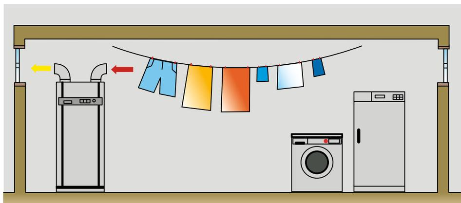
Figura 5.14: Posa di bollitori a pompa di calore per la deumidificazione di locali.
