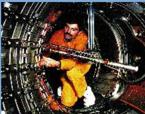
Collaborazione internazionale nel settore della **fusione nucleare**: il rivestimento della camera interna del Tokamak con carburi del boro, sviluppati in Svizzera, (nel JET, in figura) protegge in larga misura il plasma dalle impurità.
