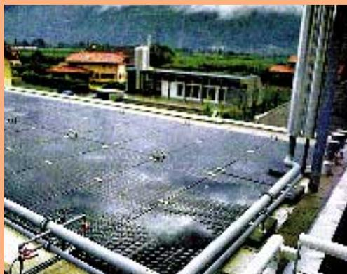
Presso la scuola tecnica intercantonale di Rapperswil funziona dal 1990 un servizio di prova e di ricerca per pannelli solari. La figura mostra l'impianto di prova all'aperto, completo di un sistema automatico di misurazione.
