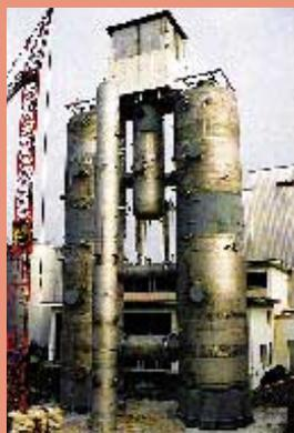
L'impianto termoidraulico PAN-DA serve a controllare il funzionamento dei sistemi passivi di sicurezza.
