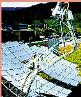
PS: nel punto focale dello specchio parabolico da 90 m<sup>2</sup> è posto un reattore solare a ciclone, riscaldato dai raggi concentrati del sole (potenza 56 kW).
