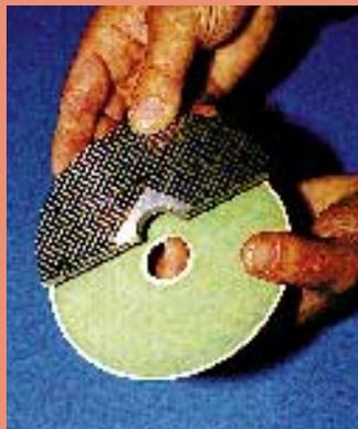
Pila HEXIS: membrana ceramica (verde) con elettrodi, piastra scanalata per l'apporto del combustibile e l'evacuazione dei prodotti della combustione.
