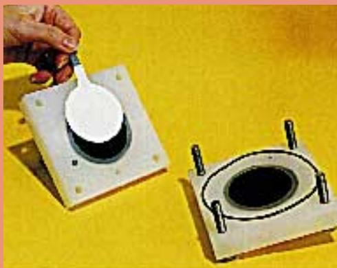
Componenti della cella zinco/aria: nella mano, l'elettrodo di zinco avvolto da un materiale spugnoso di separazione, all'interno del contenitore a destra, gli elettrodi bifunzionali ad aria.
