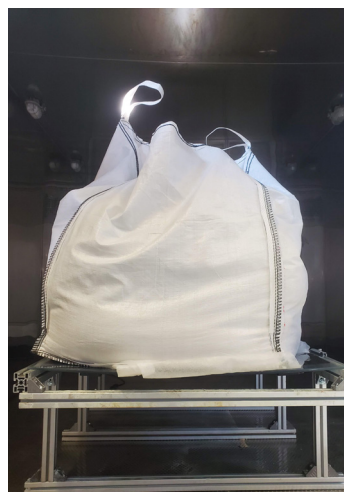
Durante i test di carico meccanico condotti presso l'istituto di ricerca OFI di Vienna, i moduli fotovoltaici sono stati sottoposti per un'ora a sollecitazioni mediante sacchi di sabbia. Le prove si sono svolte in una camera climatica in grado di raggiungere temperature fino a -40 °C. Foto: OFI/Gassner, utilizzata anche nell'articolo «Enhanced mechanical load testing of photovoltaic modules for cold and snowy climates» in (EES Solar, RSC Publishing)
