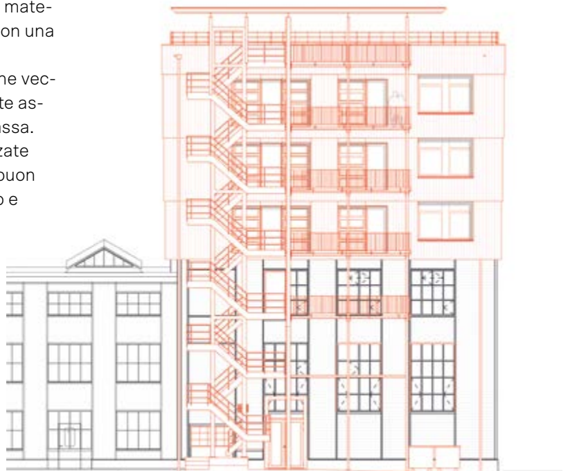
Figura 1.4: Data la varietà di formati dei profili delle lamiere in alluminio riutilizzate, e per evitare sprechi di materiale, l'involucro esterno è stato realizzato con una disposizione a scaglie. (Progetto: baubüro in situ)
