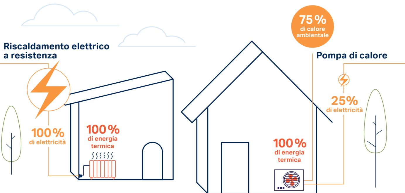
I riscaldamenti elettrici a resistenza consumano molta elettricità per produrre calore. Le pompe di calore, invece, devono utilizzare solo una parte dell'elettricità perché sfruttano il calore ambientale. Si tratta del calore naturale che viene immagazzinato nell'aria, nella terra, nella falda freatica e nelle acque di superficie.
