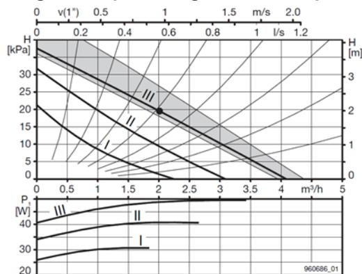
Figura 1: diagramma p/V e della potenza. Fonte: Biral MX 12
