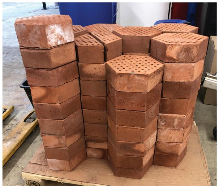
Mattoni sagomati fatti con scorie d'altoforno, testati sperimentalmente come materiale di riempimento (qui all'esterno del serbatoio). Una volta inseriti nel serbatoio, il sale fuso penetra attraverso i fori aumentando il trasferimento di calore al materiale di riempimento. Foto: Kraftblock
