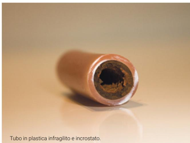
Tubo in plastica infragilito e incrostato.
