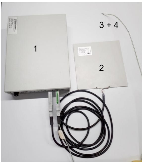
Fig. 4 Strumento di misura di Ahlborn: 1 = Registratore di dati, 2 = Piastra di flusso termico, 3 = Sonda della temperatura interna,  $\theta_i$ , 4 = Deve essere collegato almeno una sonda per la temperatura esterna,  $\theta_e$  (stesso aspetto, non mostrato in figura).
