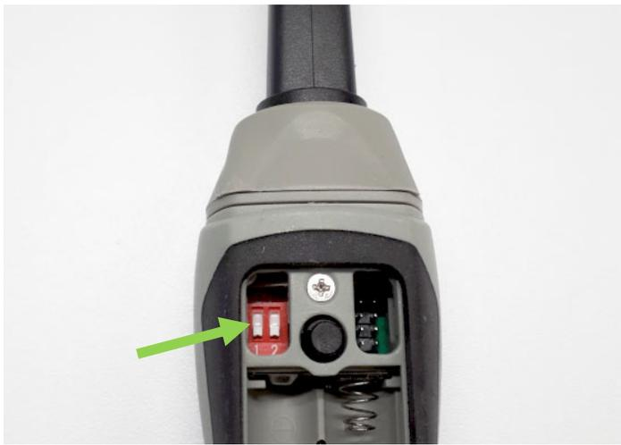
Fig. 10 Cursore per disattivare la funzione di spegnimento automatico (freccia verde) nello strumento di misura di Testo.
