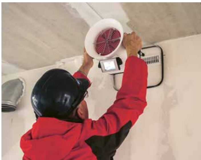
Figura 12.1: Strumento di misurazione del flusso d'aria con compensazione della pressione zero. (Fonte: ACIN instrumenten bv, BG Rijswijk NL)
