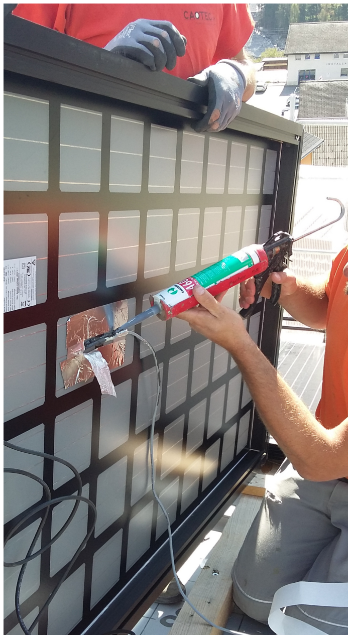
Per il project da perscrutaziun equipeschon ils perscrutaders dal SPF la vart davos d'in modul da PV cun in sensor da temperatura. Foto: rapport final da l'UFE
