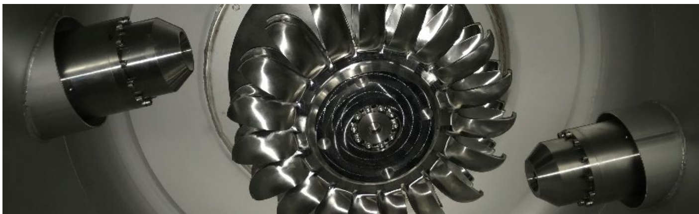
PCH da Malatray a Monthey: la ruota Pelton e i suoi due iniettori da fonti diverse (fonte: Ville de Monthey)
