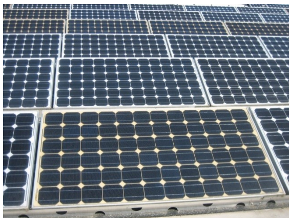
Illustration 2 : Décoloration des modules (browning), Jendra Power AG
