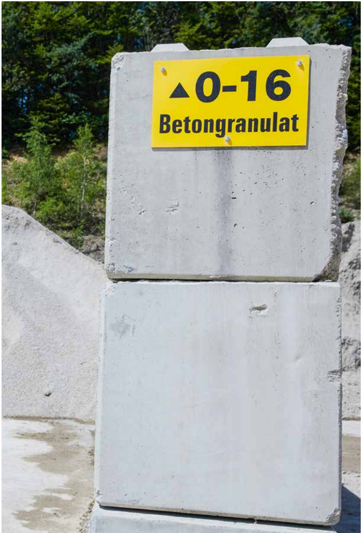
Le granulats a un diamètre maximal de 16 millimètres
