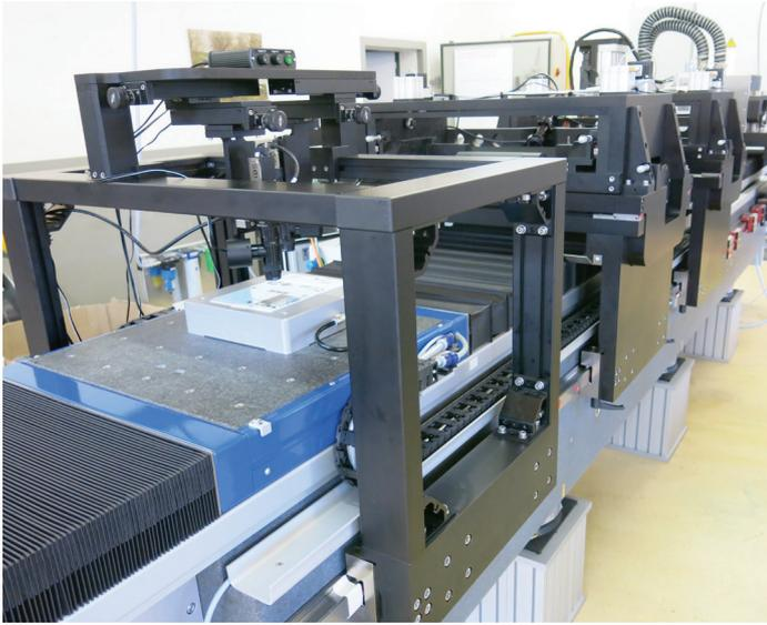
La plateforme avec laquelle sont construites les cellules solaires à l'Empa avec le procédé des buses à fente. Photo: Empa
