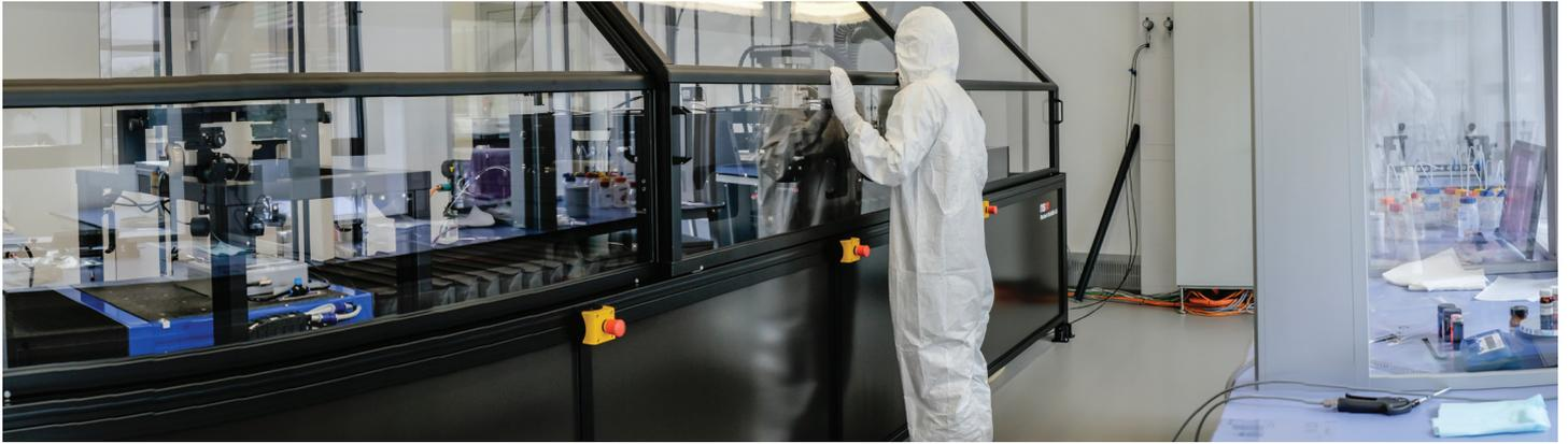
Les scientifiques de l'Empa à Dübendorf utilisent ce système pour produire des cellules solaires à base de pérovskite de 10 x 10 cm avec le procédé des buses à fente. Dans le cadre du projet de recherche UPero actuellement en cours, le processus de fabrication doit être mis à l'échelle jusqu'à une taille de cellule de 30 x 30 cm. Photo: Empa
