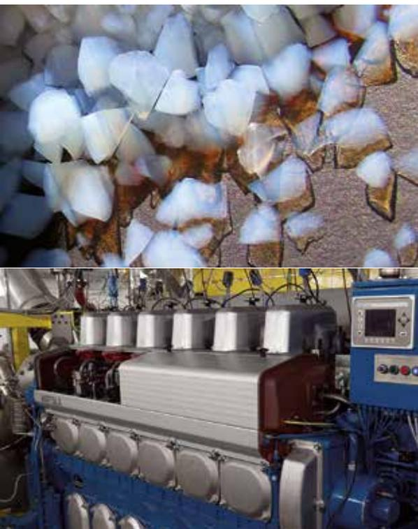
(En haut) L'aérogel à base de silice est un matériau solide léger et poreux qui est idéal pour l'isolation thermique grâce à sa faible conductivité thermique (source: Empa). (En bas) Banc de test pour les moteurs (source: PSI).
