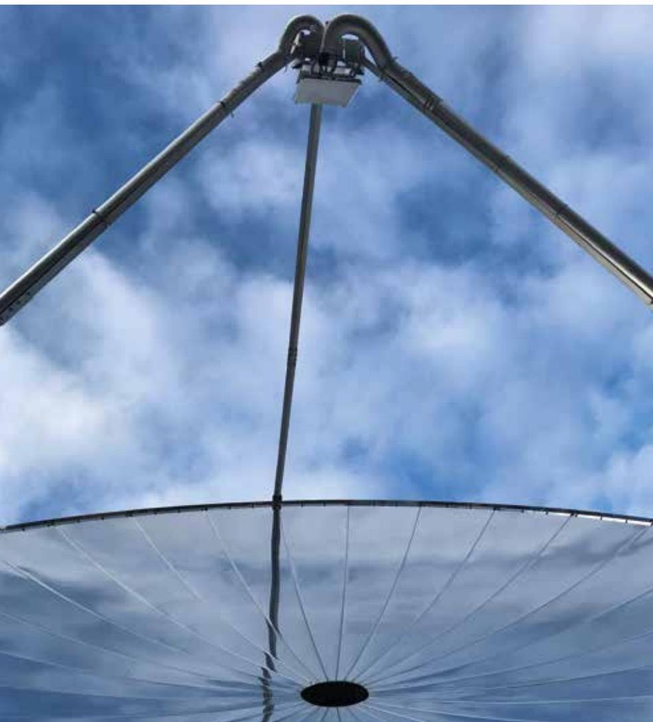
Concentrateur solaire du Laboratory of Renewable Energy Science and Engineering de l'EPFL pour la production de gaz renouvelable (hydrogène). La combinaison d'un système photoélectrochimique à énergie solaire et d'une gestion intelligente de la chaleur permet de convertir l'énergie solaire en hydrogène avec des rendements jusqu'à 17% (S. Tembhurne, F. Nandjou & S. Haussener, Nature Energy 4, 399-407, 2019).
