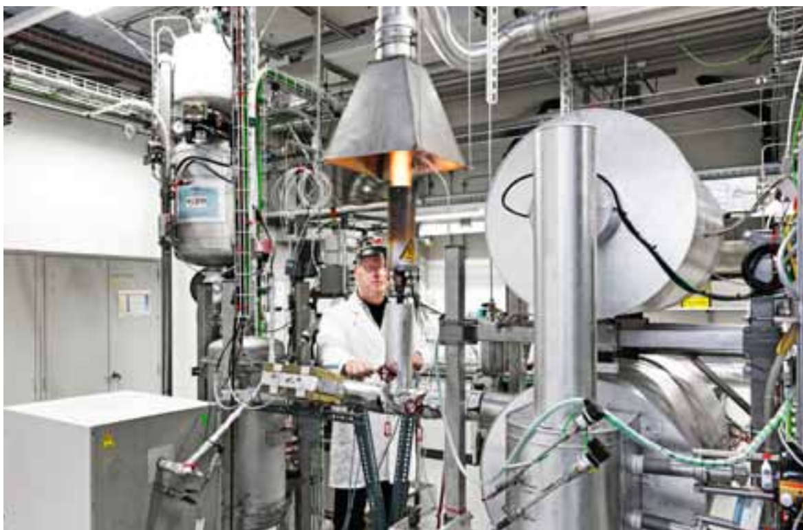
Les chercheurs de l'Institut Paul Scherrer PSI utilisent cette installation de laboratoire pour extraire d'une matière première naturelle, le bois, du gaz riche en énergie: le processus transforme le bois en un gaz synthétique qu'il est possible d'injecter dans les conduites publiques. L'énergie fournie par le bois est ainsi utilisable pour produire de l'électricité dans des centrales à gaz ou pour la propulsion de véhicules. L'énergie qui est exploitée est très respectueuse de l'environnement, car la gazéification du bois est neutre du point de vue du CO 2 . (Scanderbeg Sauer Photography)
