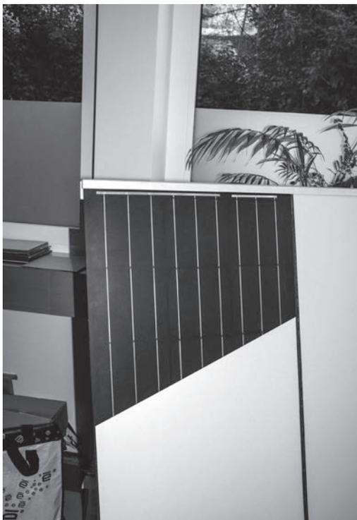
Un coup d'œil derrière la peau nanotechnologique du module solaire blanc, développé au CSEM.
