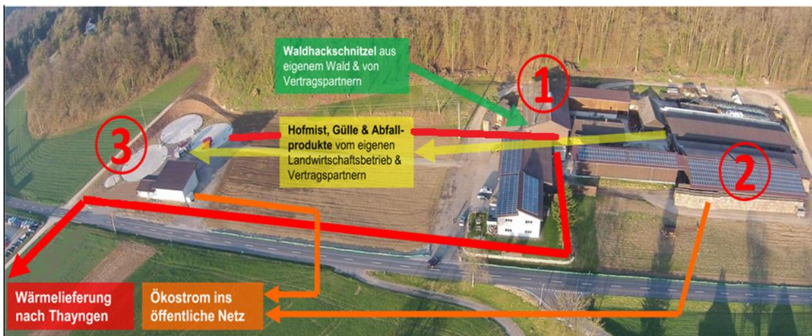
Figure 10: Vue aérienne de l'entreprise agricole «Unterbuck» à Thayngen (SH) avec système de chauffage à copeaux de bois (1), installation photovoltaïque (2) et installation de biogaz avec cogénération (3).
