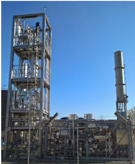
Figure 3 : Tour de réacteur à gauche, skid pour gaz avec torche à droite
