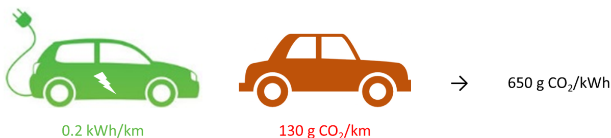
Figure 3: Energie moyenne consommée par une voiture électrique en comparaison aux émissions moyennes de gaz à effet de serre d'une voiture à combustion. Le remplacement d'une voiture à combustion par une voiture électrique permet d'éviter 130 g CO 2 /km, soit 650 g CO 2 /kWh.
