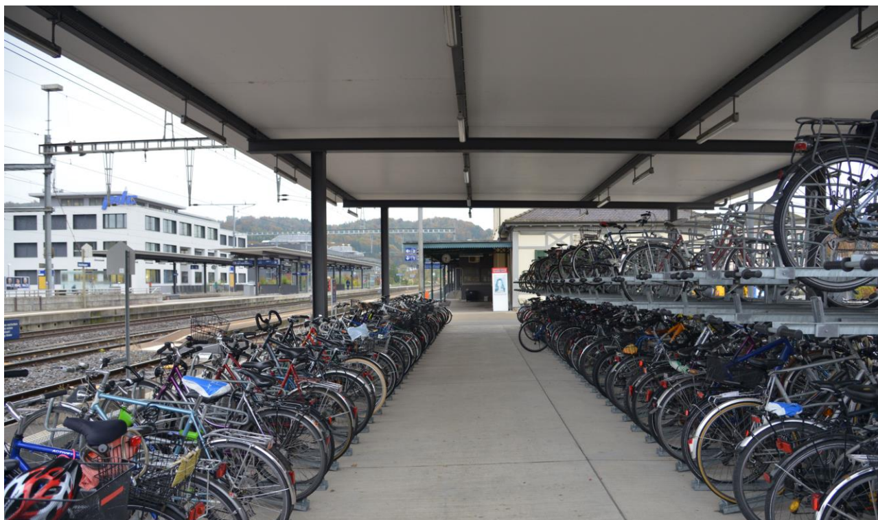
Figure 13 – Gare de Wettingen : stationnement vélo sécurisé et protégé sur le quai et au contact direct du bâtiment de gare ; les étriers de roue ainsi qu'un élément physique (muret) assurent la séparation physique entre le quai et le stationnement vélo.
