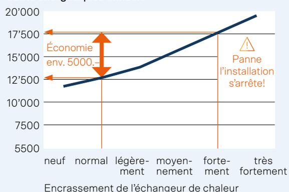
Graphique: Coûts énergétiques annuels d'une installation dotée d'une puissance frigorifique de 210 kW avec des échangeurs de chaleur à différents degrés d'encrassement.
