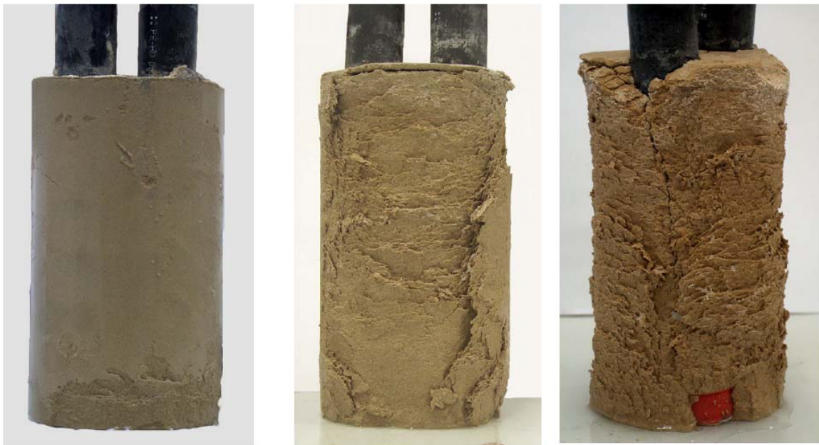
Fig. 6 Mélange prêt à l'emploi après 0, 2 et 4 cycles de gel-dégel
