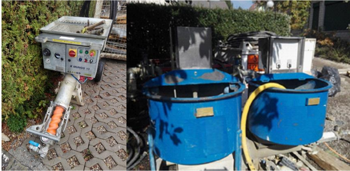
Figure 7 Pompe mélangeuse à mortier simple (à gauche) et malaxeur colloïdal (à droite)
