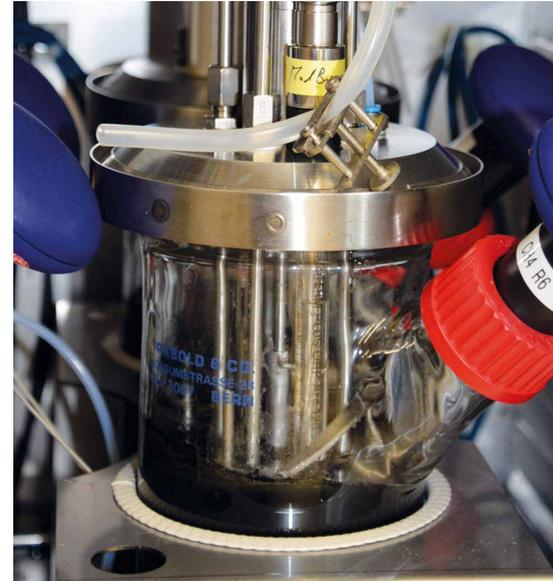
Réacteur pilote pour le traitement microbien aérobie de la biomasse peu fermentable (source : HES-BE)
