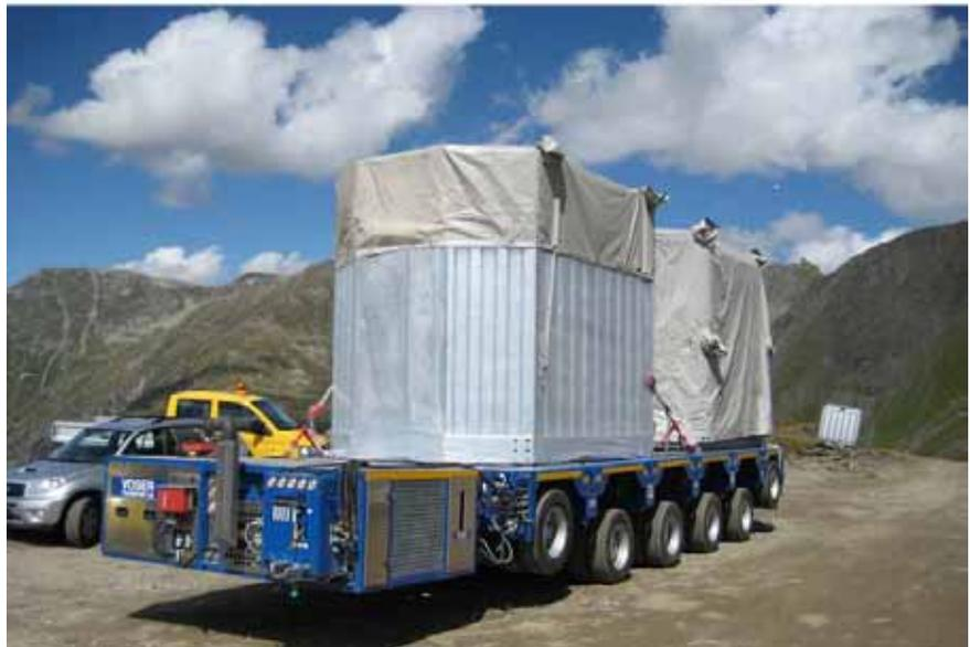
Figur 5: Transportkombinationen zur Erschliessung von schwierig zugänglichen Standorten im Gebirge mit kippbaren Flügeladaptern (Quelle: New Energy Scout).
