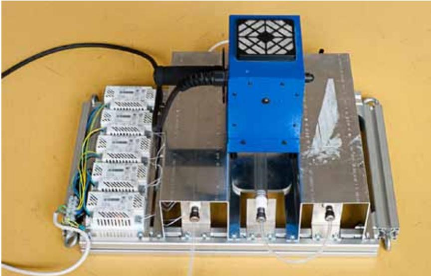
Figur 2: Migro-Smog-Kammer zur Erzeugung von sekundären organischen Aerosolen aus Abgasen mittels UV-Strahlung (Quelle: FHNW).
