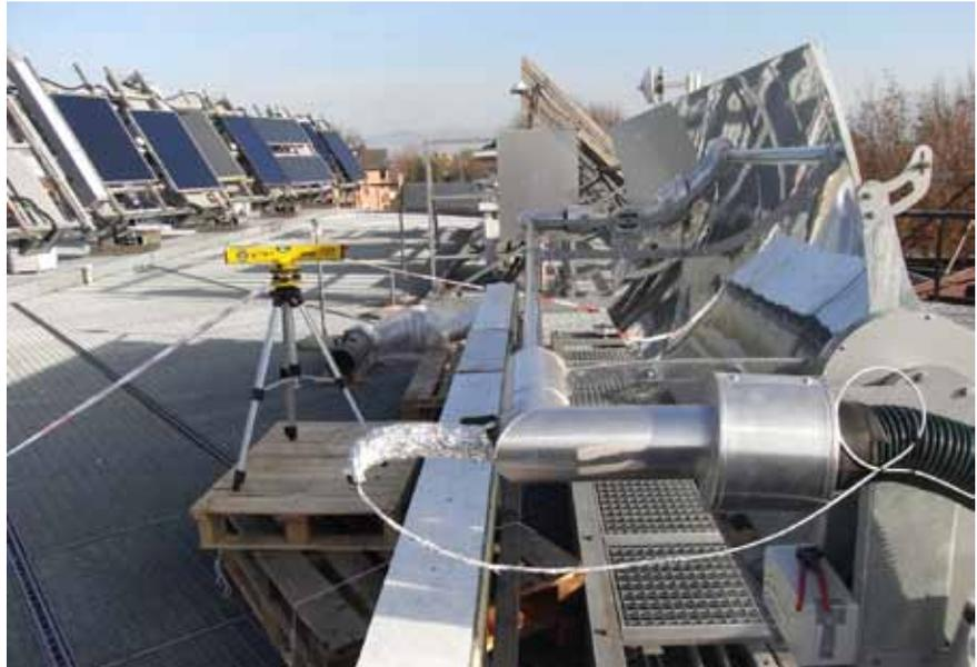
Figure 1 : Installation de mesure par laser pour la vérification de la qualité de la géométrie de l'élément réflecteur.
