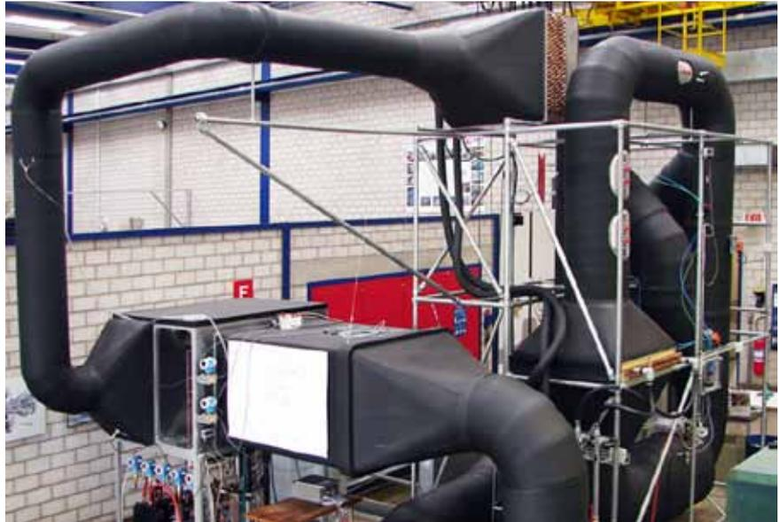
Figur 1: Versuchsanlage der HTA Luzern zur Untersuchung von drehzahlvariablen Luft/Wasser-Wärmepumpen [5]. Sowohl der Kompressor wie auch der Ventilator werden drehzahlgeregelt.
