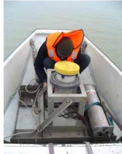
Figur 3: Feldmessungen im Grimselsee mit einem Acoustic Doppler Current Profiler (ADCP) zur Messung von vertikalen Geschwindigkeitsprofilen, die sich während des Pump- und des Turbinierbetriebs ausbilden.
