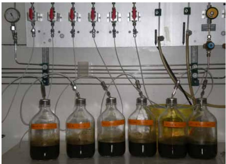
Figur 1: Vorbereitung des Batch-Tests: Spülung des Gasdoms mit  $N_2/CO_2$  (Quelle: EPFL).
