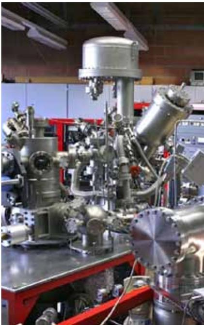
Figure 2 : La thermochromie au laboratoire dépend des chercheurs et de leurs outils. Vue sur la chambre de dépôt UHV développée par le LESO pour ses créations de nanocouche [1].
