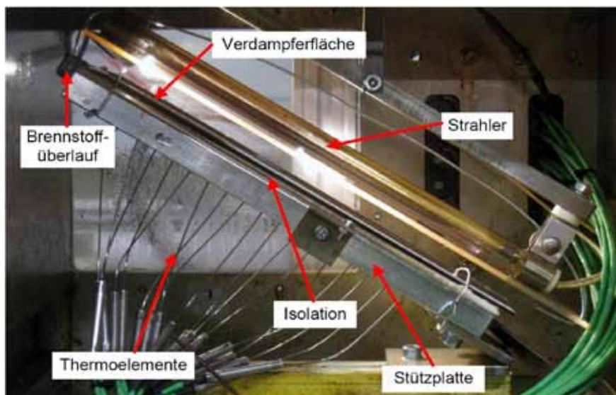
Figur 2: Prüfstand für die Untersuchung der Verdampfung eines Brennstofffilms nach dem CatVap-Verfahren. Im realen System reagiert ein Teilstrom des verdampften Brennstoffs mit einer katalytisch wirkenden Oberfläche und erzeugt die Strahlungswärme zur Beheizung der Fläche. Für die Versuche wurde ein elektrisch beheizter Strahler eingesetzt.
