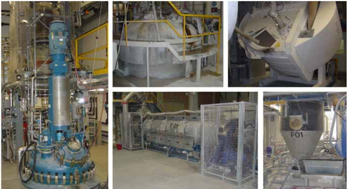
Figur 2: Apparaturen für die Zeolith-Herstellung: Säureaustausch-System zur Modifizierung von Zeolithen (links), Synthesereaktor zur Herstellung der Zeolith-Kristalle (17 m<sup>3</sup>, oben mitte), Granulierteller zur Herstellung von runden Kugeln (rechts oben), Drehrohröfen zum Trocknen von Zeolithpulver (unten mitte), Filtrationssystem zum Filtrieren und Waschen der Zeolith-Kristallen (unten rechts).
