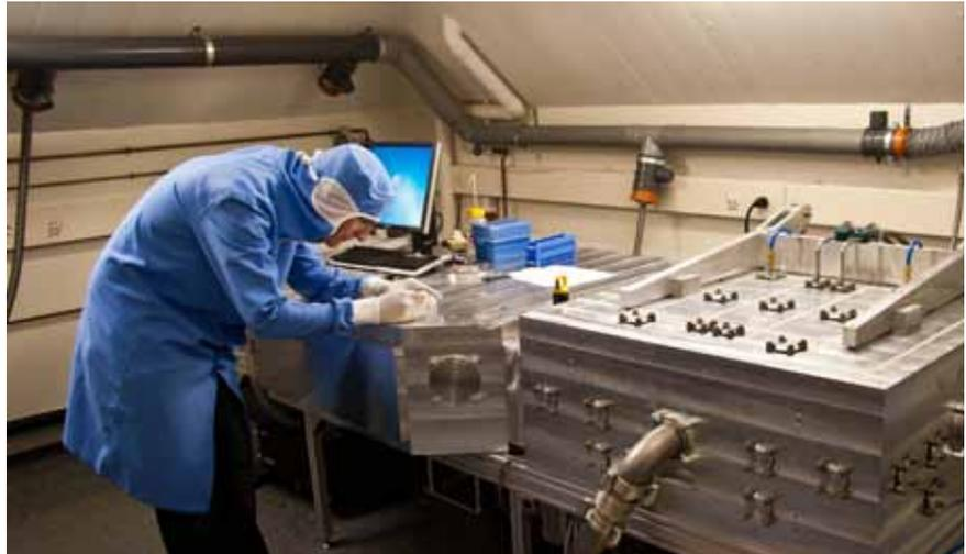
Figur 1: Neues PECVD Depositionssystem Octopus von Indeotec am PV-Lab des IMT mit automatischer Beladung von 10 Proben (Bildquelle: PV-Lab, IMT, EPFL).
