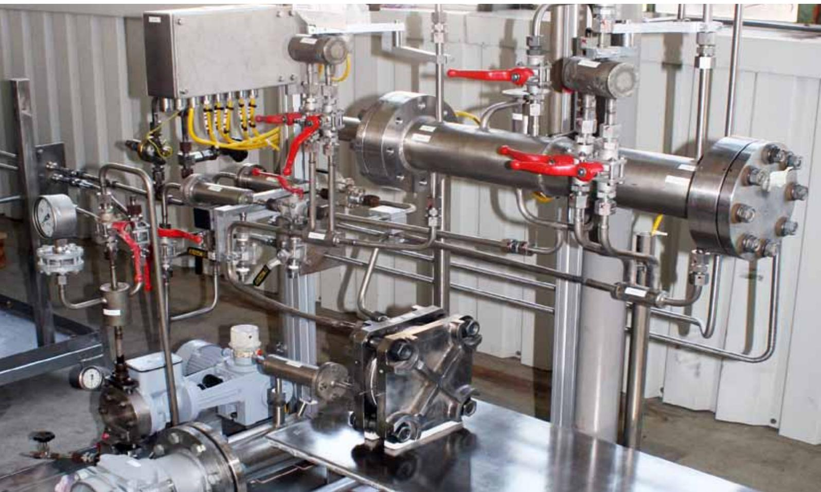
**Titelbild:****Vollautomatisierte Pilotanlage zum Testen neu entwickelter Diaphragmen für den Einsatz in hoch effizienten Hochdruckelektrolyseuren**
