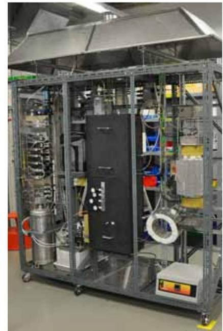
Figur 5: Laborversuchsanlage für Katalysatoruntersuchungen mit schwefelhaltigen Gasgemischen, z.B. simuliertem Produktgas aus der Biomassevergasung (Quelle: PSI).
