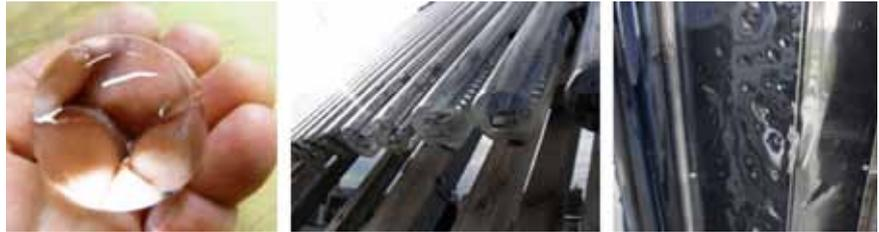
Figure 5 : Les tests de qualité des capteurs intègrent un test de grêle de plus en plus sévère vu les modifications climatiques (SPF).
