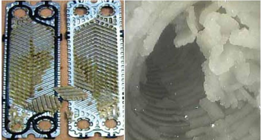
Figure 1 : Les modules de préparation d'eau chaude sanitaire solaire externe peuvent aussi être sujets à entartrage mais en principe moins que les systèmes avec échangeurs immergés (SPF [7]).
