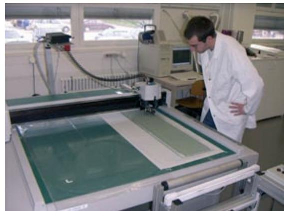
**Figur 10:** Die computergesteuerte Bandschneidvorrichtung erlaubt die Produktion von Zellen jeglicher Grösse
