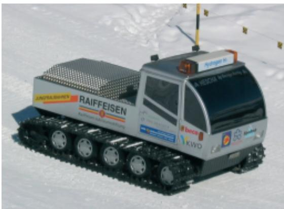
Figur 2: Mit Wasserstoff angetriebenes Pistenfahrzeug.
