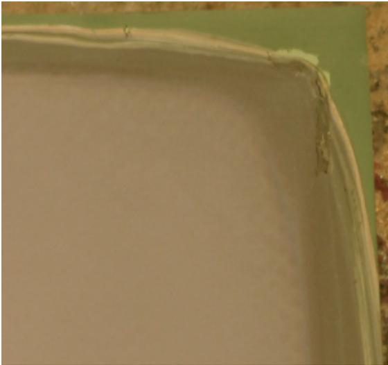
**Figur 2:** Lokale Reoxidationszone in der Ecke einer Zelle
