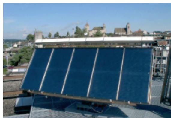
**Figure 2:** nouveau banc test de capteurs permettant de tester un ensemble de 12,5 m<sup>2</sup>, développé par le SPF
