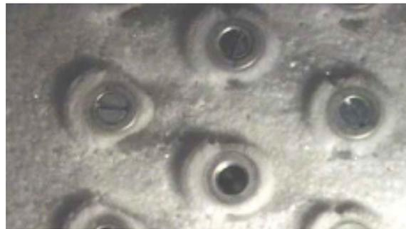
**Figur 4:** Vereister Versuchskühler im Projekt LOREF 1 [24] ; Luftströmung von rechts nach links. Deutlich ist die Anreicherung an Frost im Ablösegebiet der Zylinder, die die Verdampferrohre symbolisieren, zu sehen.
