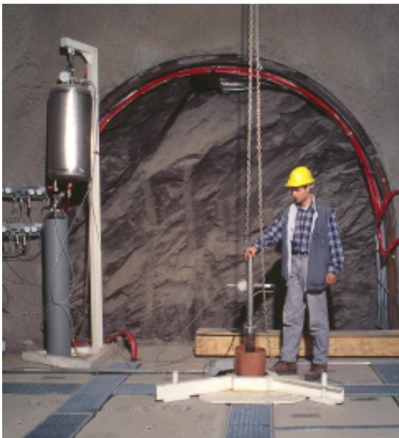
**Bild 3:** Felslabor Mont Terri – Nische des Heater-Experimentes, das hauptsächlich zur praktischen Überprüfung von Rechenmodellen dient (Comet).
