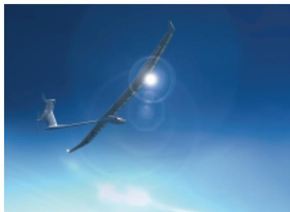
Figur 10: Photovoltaisch betriebenes Flugzeug (Bildquelle Oxyde.ch – Sapisiti / ©EPFL Solar Impulse)
