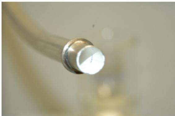
**Figur 5b:** Post-test Photographie der inneren Oberfläche des Dampferzeuger-Rohres mit Aerosolablagerung.
