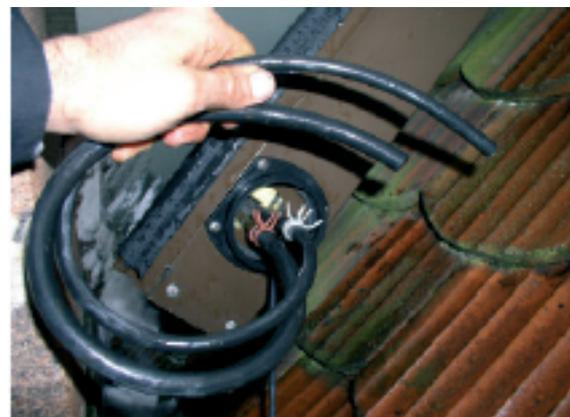
**Figur 12:** Elastomer - Flextube nach 2 Betriebsjahren: die hohen thermischen Belastungen liegen im Bereich der ersten 30 cm. Von aussen sind keine Verfärbungen und Aushärtungen des Schlauches feststellbar. (Fotos: Solarenergie Prüf- und Forschungsstelle, SPF)
