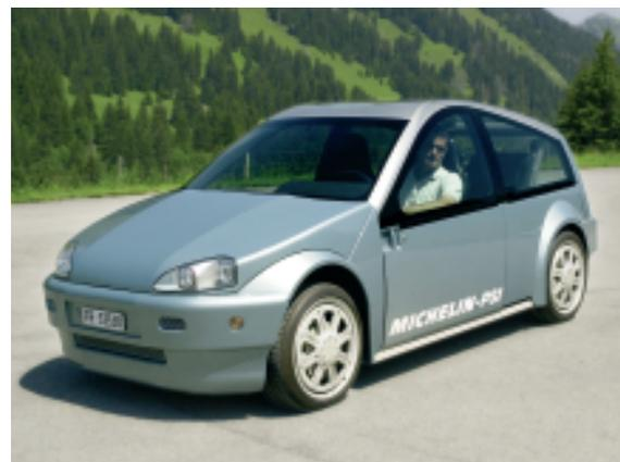
**Figur 5** Der *HY-LIGHT* setzt als Zwei-Liter-Auto mit Brennstoffzellenantrieb neue Massstäbe.
