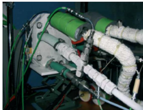
**Figur 7** Versuchsaufbau mit gekühlter (-10°C) 200 cm<sup>2</sup> Zelle
