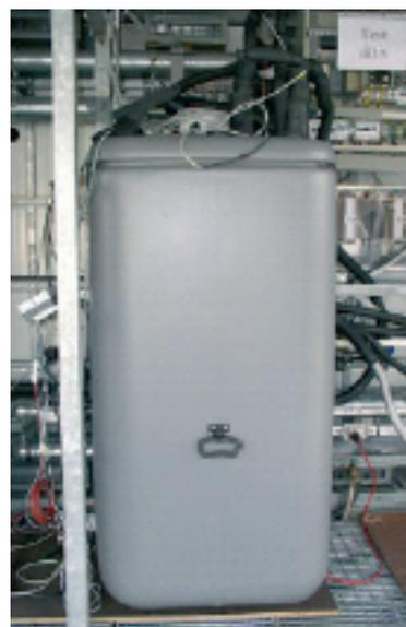
**Figure 7:** une cuve sans pression dans un kit solaire: un avantage si les échangeurs sont correctement dimensionnés ; ce que le banc test révèle, entre autres paramètres (SPF)
