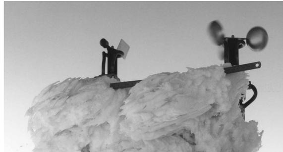
Geheizte Windgeschwindigkeits- und -richtungsgeber der Anlage Grenchenberg – nach einer Woche Reifansatz !
