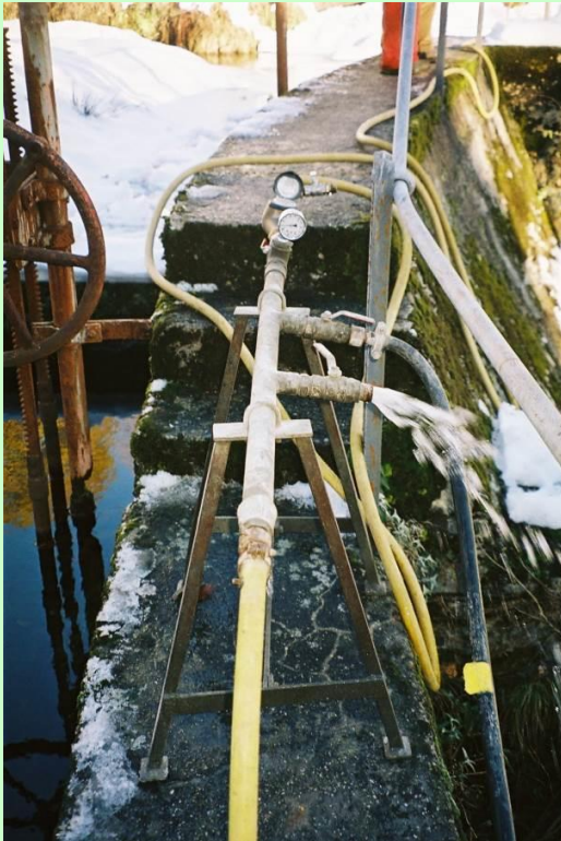
Perméabilité: essai «Lugeon»
