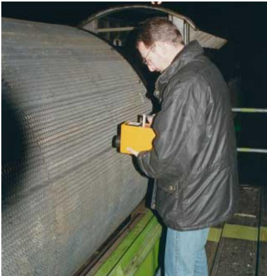
*Après son chargement sur le wagon de chemin de fer, le conteneur de transport pour assemblages combustibles irradiés fait encore une fois l'objet d'une mesure précise du rayonnement dûment notée.*
