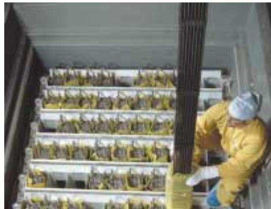
*Les assemblages combustibles neufs sont stockés à sec jusqu'à leur chargement dans le coeur du réacteur. Ils sont soumis à des contrôles optique et mécanique de la qualité lors de leur livraison.*
