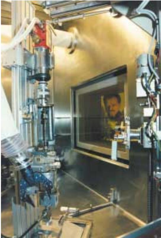
*Examen d'un matériau dans une cellule chaude du PSI. C'est ici que sont déterminées les propriétés mécaniques des matériaux prélevés sous forme d'échantillons dans les centrales nucléaires.* Source: PSI
