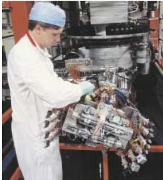
Préparation à la mise en œuvre d'un dispositif mécanisé d'examen des cordons de soudure de la cuve du réacteur.
