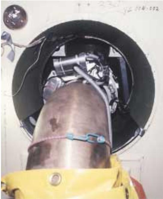
*Examen des cordons de soudure d'un manchon de raccordement de l'une des conduites de recirculation à la cuve du réacteur à l'aide d'un dispositif mécanisé*
