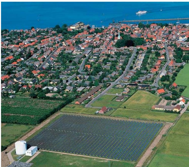
**Figure 2** : exemple de champ solaire lié à un réseau à basse température, Marstal au Danemark (photo ville de Marstal 2006, [www.solarmarstal.dk](http://www.solarmarstal.dk))
