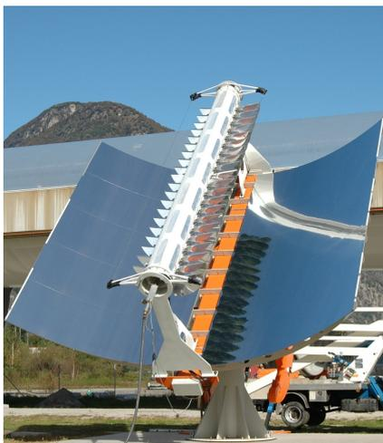
Figure 3 : Dernier prototype d'absorbeur développé en 2011 et monté sur une installation de mesure consistant en deux sous-systèmes: le premier est composé par le concentrateur principal et le système de suivi du soleil tandis que le deuxième est composé par le concentrateur secondaire et le tube pour l'air de processus.
